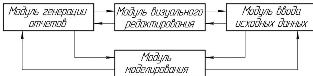
Рис. 1. Структурная схема программного продукта для имитационного моделирования процесса гидроабразивного резания
